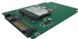
步驟1: 將mSATA SSD 插入 mini PCI-e插座(如圖步驟1)
